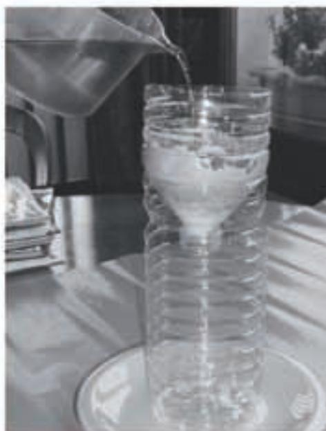
2. Verser l'eau colorée sur l'argile, dans l'entonnoir. Attendre : l'eau ne passe pas, elle est bloquée par l'argile.
