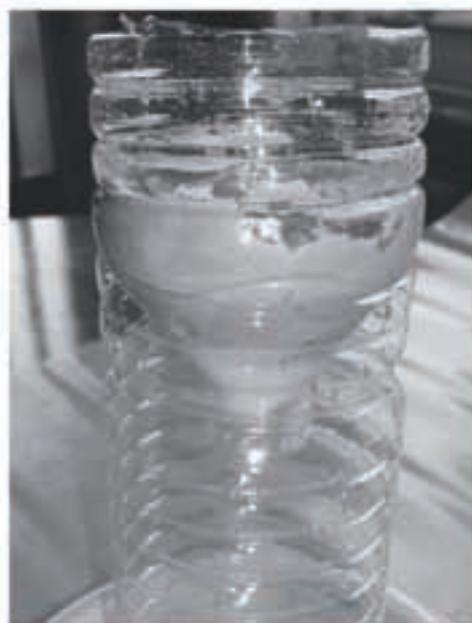
1. Placer un tampon de coton dans le goulot. Tapiser soigneusement la surface de l'entonnoir avec de l'argile (sur 4 cm environ). Ne laisser aucun interstice entre l'argile et les parois de la bouteille.
