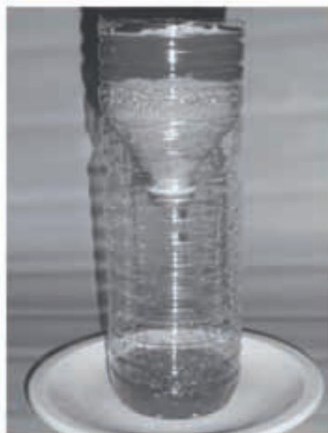
3. Recommencer avec une seconde bouteille, mais remplacer l'argile par du sable. Des gouttes d'eau passent.
