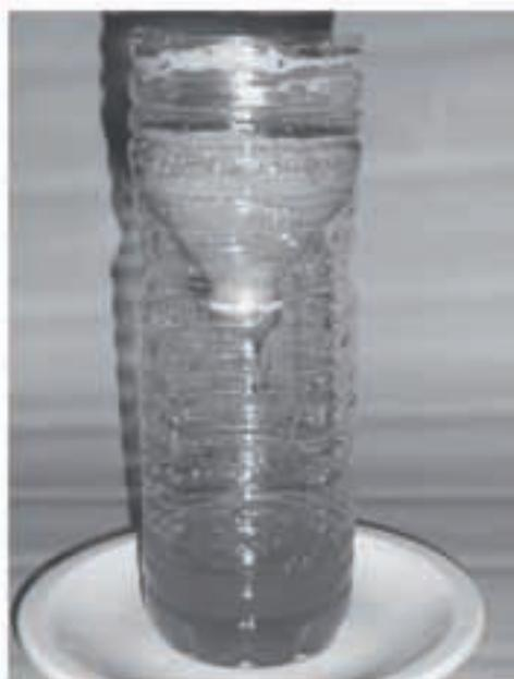
4. Au bout de quelques minutes, toute l'eau est passée, traversant le sable. Le sable n'est pas imperméable.
